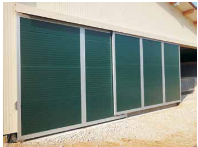
Schiebetor doppelflügelig ISO Sandwichpaneel in Alu Rahmen mit U-Bodenführung im Torblatt. Wetterschutzblende für Laufschiene und Muffen.
